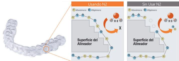
Cambio de estado de la superficie del alineador con y sin N<sub>2</sub>, muestra por qué necesita N<sub>2</sub> para el poscurado
