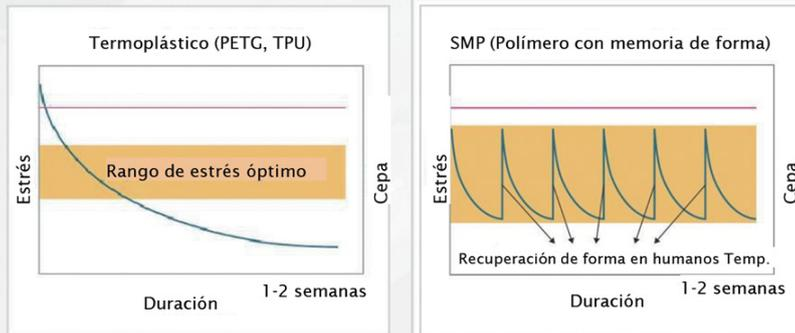
Los Alineadores fabricados con láminas termoplásticas convencionales tienen una gran fuerza inicial, lo que sobrecarga los dientes (causando dolor), luego disminuye rápidamente a menos de la fuerza adecuada y, como resultado, no pueden mantener la fuerza de ortodoncia. lo que dificulta obtener el resultado de ortodoncia deseado.
